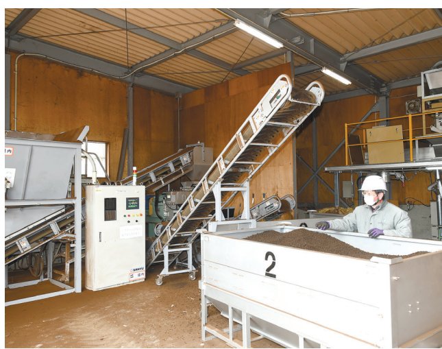
堆肥を作る「土づくりセンター」内に導入したペレット製造装置
