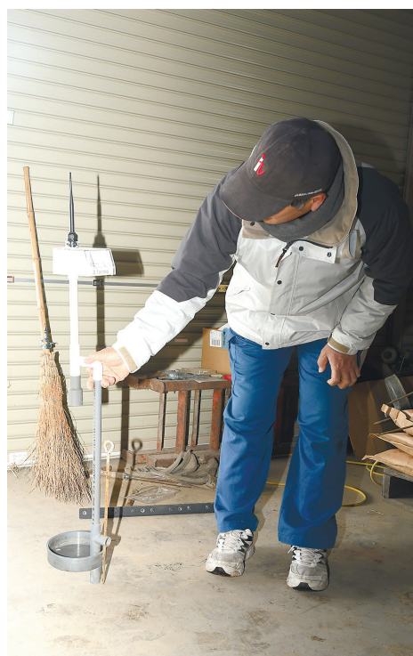
水管理のため導入した水位センサー。水田に設置し、水位や温度を計測。アプリで確認できる
