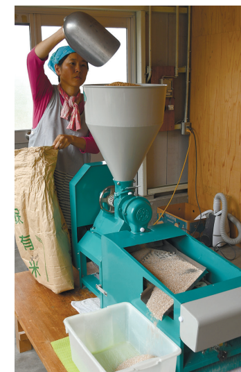
小麦の実を製粉機に掛ける清水さん。ふるいに掛け、手前左にふすま、右下に全粒粉が出てくる。一番細かい小麦粉は奥の引き出しにたまる
